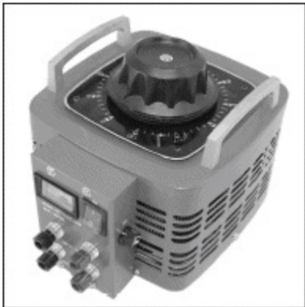
**Fig. 1** - Trasformatore variac con voltaggio regolabile mediante la manopola circolare graduata posta sulla parte superiore. I morsetti a vite con pomello di colore rosso e nero per i diversi cavi di corrente alternata in entrata e uscita possono essere disposti in coppia in senso verticale o orizzontale (un pomello rosso e nero a sinistra e un pomello rosso e nero a destra, oppure due pomelli neri a sinistra e due pomelli rossi a destra).
