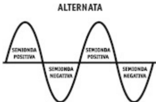
**Fig. 4** - Onda in corrente alternata.
