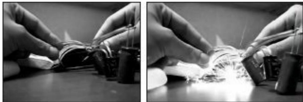
**Fig. 33** - Esempio di scaricamento di condensatori carichi in parallelo attraverso un corto circuito.
