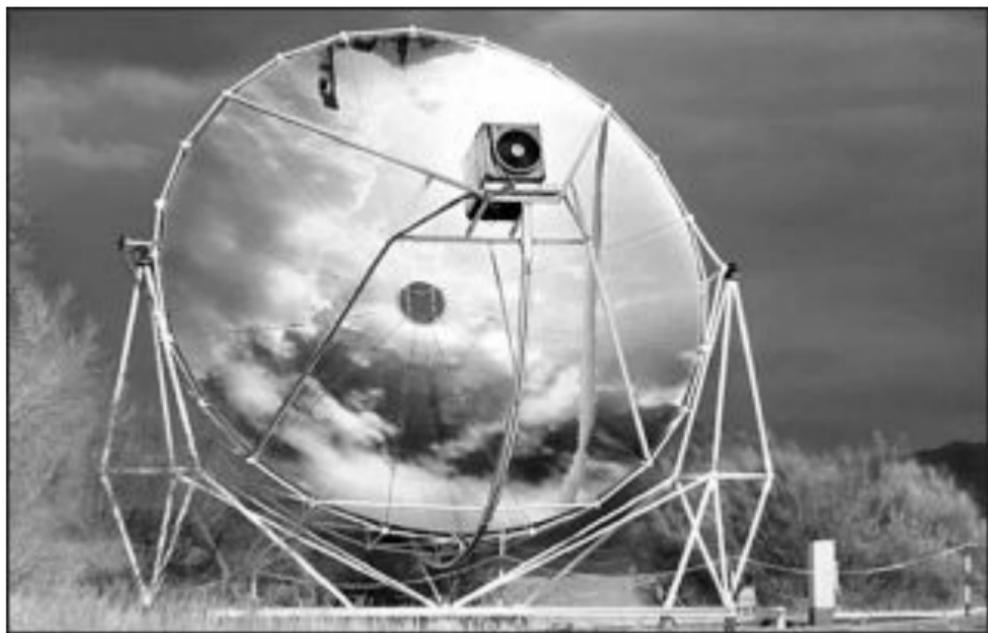
**Fig. 6** - Generatore elettrico con motore Stirling solare.
