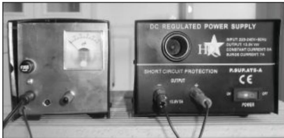
**Fig. 2** - Nell'immagine il trasformatore a corrente continua (a destra) collegato a un dispositivo per l'alta tensione da 30 kV (a sinistra).
