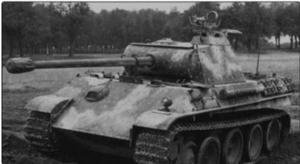
Un carro armato Mark V “Panther” con visore notturno a infrarossi.
