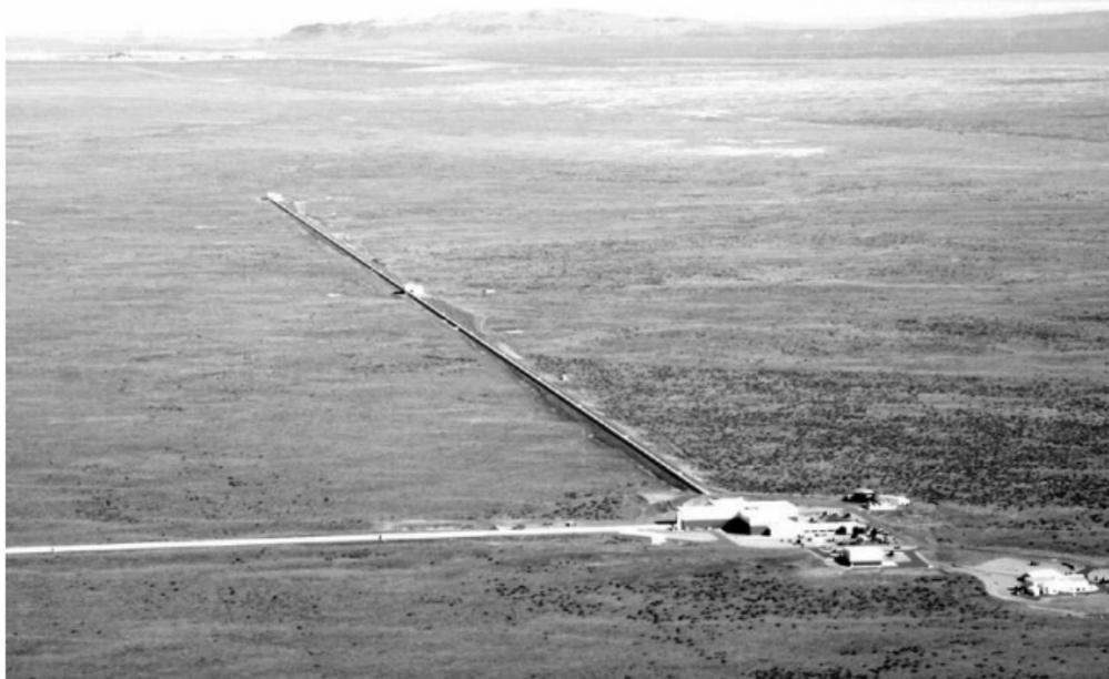
Figura 13. Un'immagine aerea del LIGO a Hanford, nello Stato di Washington. I due bracci dell'interferometro sono lunghi, ciascuno, quattro chilometri.
