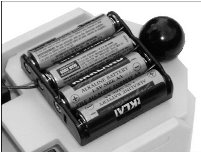
Figura 8.4 Quattro batterie da 1,5 V in un portabatterie producono circa 6 V, fruibili attraverso i cavi rosso e nero.
