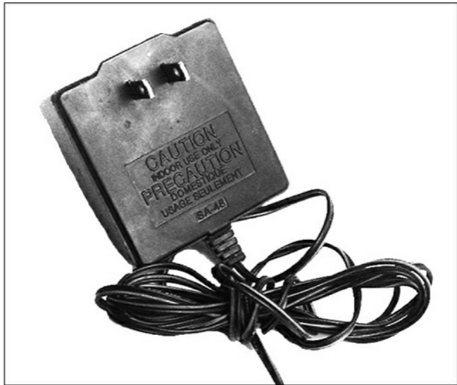
Figura 8.5 Un trasformatore vi evita di entrare in contatto con la corrente alternata domestica.
