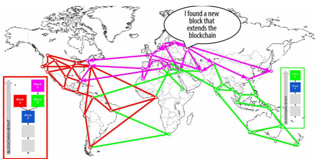
Figure 5. Visualización de un evento bifurcación de la cadena de bloques: un nuevo bloque extiende una bifurcación
