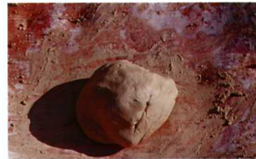
Gotowa do użycia glina połączona z materiałem schudzającym.
