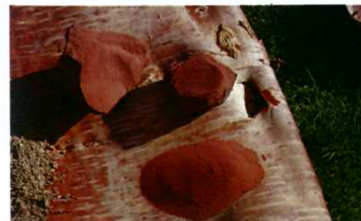
Wyprażony i rozkruszony piaskowiec przygotowany do użycia jako materiał schudzający.
