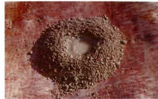
Wysuszona i rozkruszona glina jest mieszana z materiałem schudzającym i wodą.
