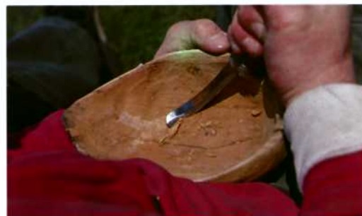
Żłobienie zagłębienia w drewnianej misce przy użyciu wygiętego noża.
