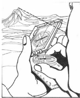
Figura 7.67 - Rilevamento di un azimut. Trovandosi nel punto A, l'azimut della quota 1873 è di 45^\circ ,
